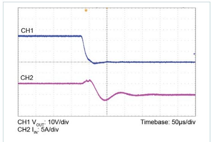
Figure 11 — Short Circuit with 24V<sub>IN</sub> to 24V<sub>OUT</sub> at 5A
