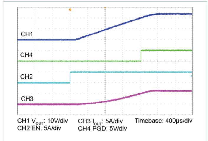
Figure 10 — Start-up with 24V<sub>IN</sub> to 24V<sub>OUT</sub> at 5A
